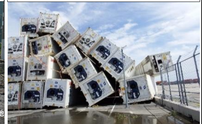
倒壊した空コンテナ（横浜港）
