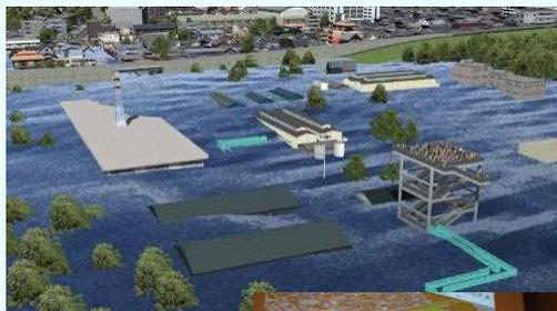
津波対策におけるコンサルティング過程において、動的な波の動きを考慮した津波解析結果、緊急時の車両交通をマイクロモデルによりシミュレーションした避難解析結果を総合的に考慮した結果を導き出している。これらの結果を、同一のVR空間内で可視化を行ない評価することで、従来型のコンサルティング手法に比べ多大な効果を得ることが可能となっている。
